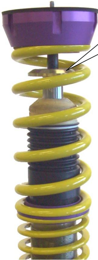
Original Stützlager auf das Federbein aufstecken und mit der mitgelieferten Mutter verschrauben. Auf der Oberseite des Stützlagers wird die Originalstützscheibe verwendet, auf der Unterseite die mitgelieferte. Das Anzugsdrehmoment der Kolbenstangenbefestigung beträgt 50 Nm. Die Montagehinweise zum Einbau des Federbeines in das Fahrzeug entnehmen Sie bitte den Unterlagen des Fahrzeugherstellers.
