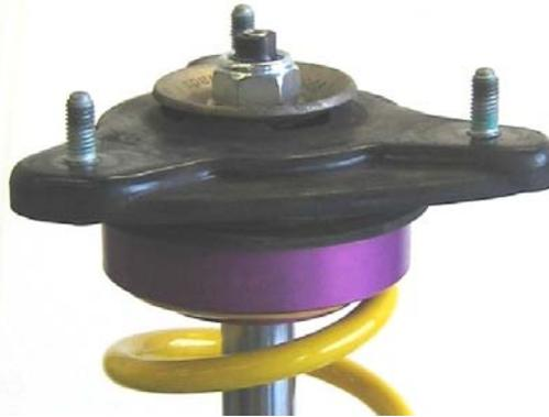
Original Stützlager mit der originalen Gummiauflage aufstecken und mit der mitgelieferten Stopmutter verschrauben. Auf der Oberseite des Stützlagers wird die Originalstützscheibe verwendet, auf der Unterseite die mitgelieferte. Das Anzugsdrehmoment der Kolbenstangenbefestigung beträgt 50 Nm. Die Montagehinweise zum Einbau des Federbeines in das Fahrzeug entnehmen Sie bitte den Unterlagen des Fahrzeugherstellers.
